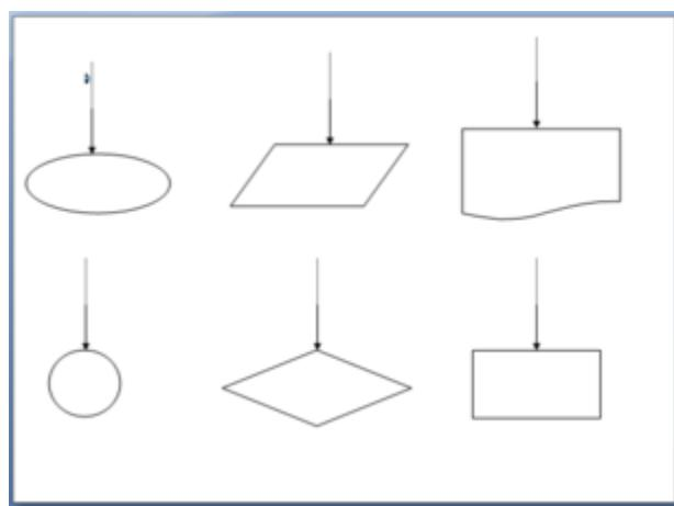
4. El diagrama de flujo debe ser construido de arriba hacia abajo y de izquierda a derecha
